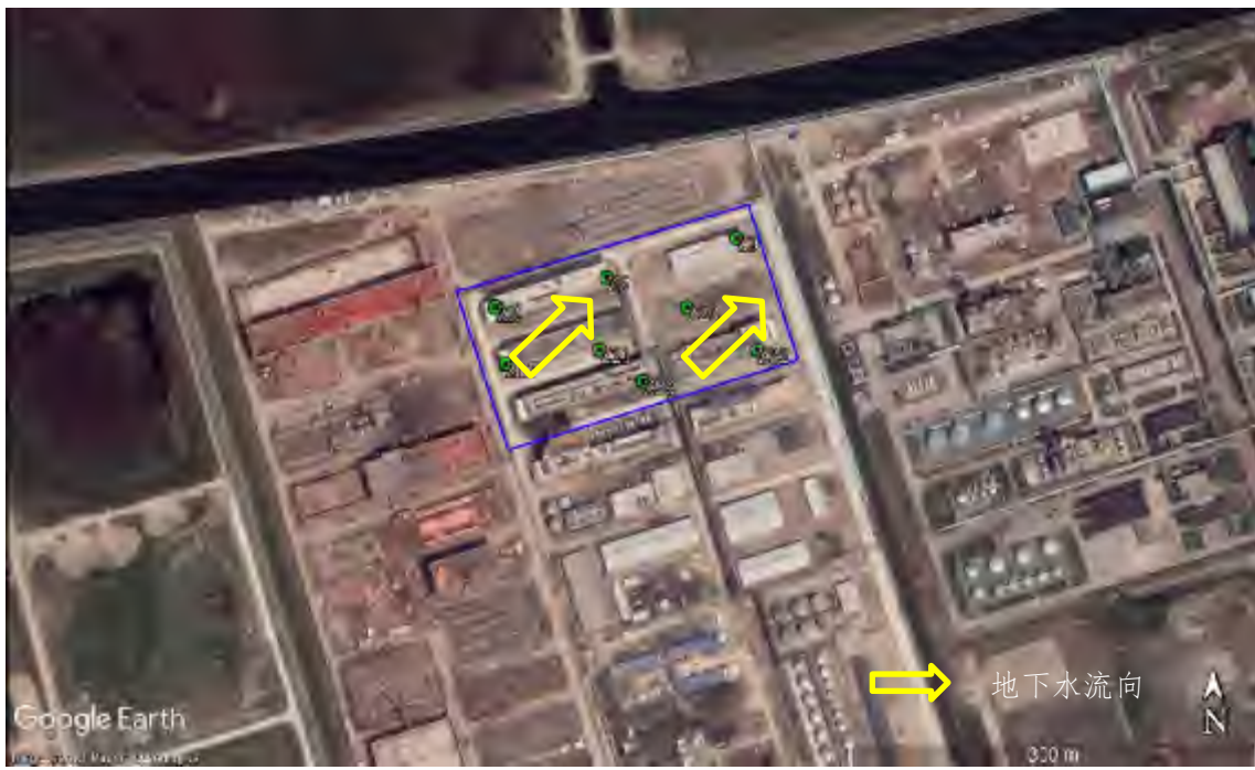
图 3.2-2 引用地勘地块内地下水流向图
